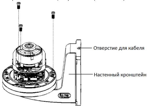
Рисунок 2-11 Установка камеры на настенный кронштейн
